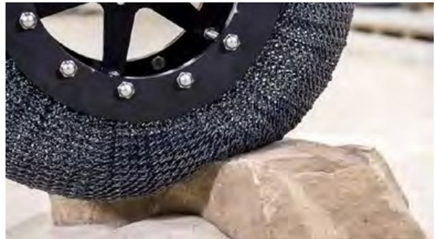
Figure 3 : Roue en NiTiNol pour des rovers martiens @NASA
