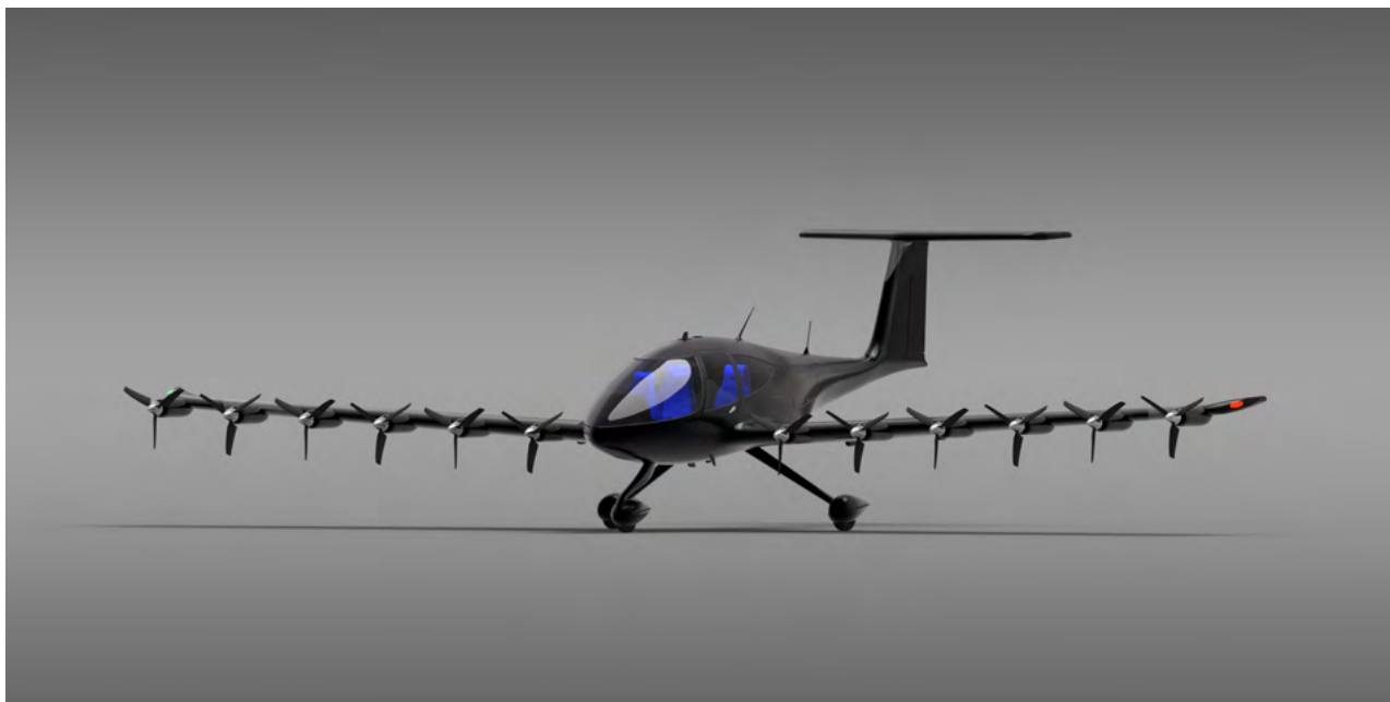
L'avion BSA et ses 12 pods à hydrogène
