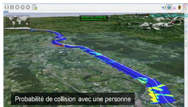
Figure 5. DGAC-PHYDIAS : Calcul de probabilité de collision de drones avec une personne à l'aide de l'outil DROSERA « DRONES Simulation Environment for Risk Assessment »
