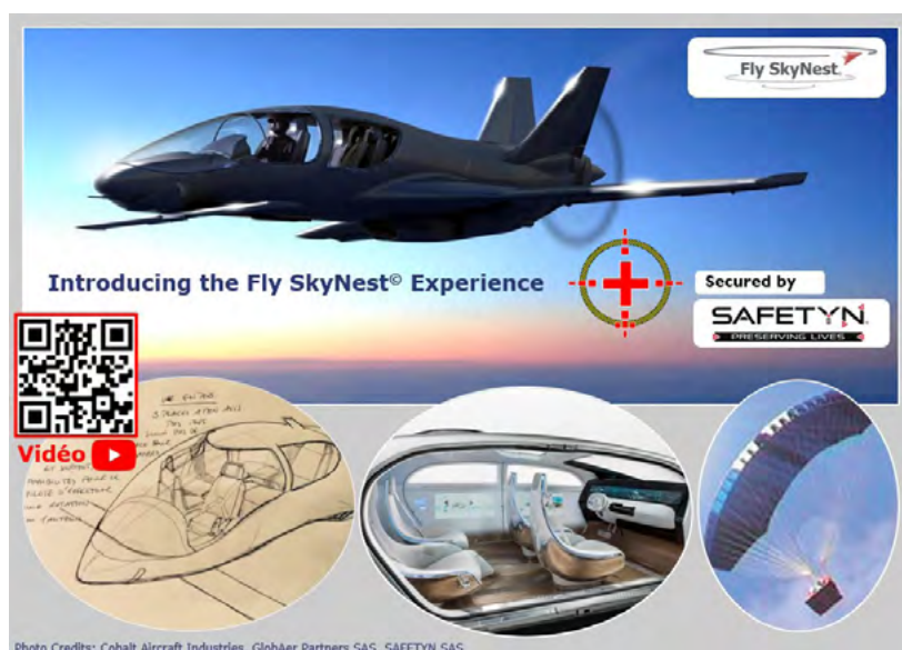
Figure 1. Description du concept « Fly Skynest » très automatisé et très sécurisé sur base d'un aéronef à voilure fixe, doté d'un parachute balistique de secours, activé manuellement par le Safety Pilot ou automatiquement par un Centre névralgique de sécurité des vols « UAM-SAFETYN'Box »
