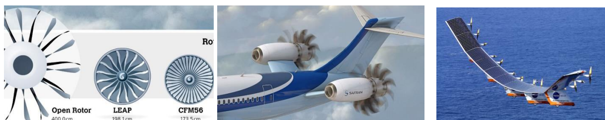
Figure 1 (G) Diamètre Open Rotor Vs moteurs actuels ©Safran; (C) Open Rotor installé ©Safran; (D) Pathfinder ©NASA.
