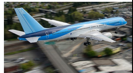
Soufflage par jets sur la dérive (Boeing ecoDemonstrator 757)
