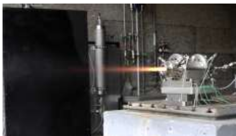
Figure 1- Moteur hybride de recherche HYCOM de l'ONERA
