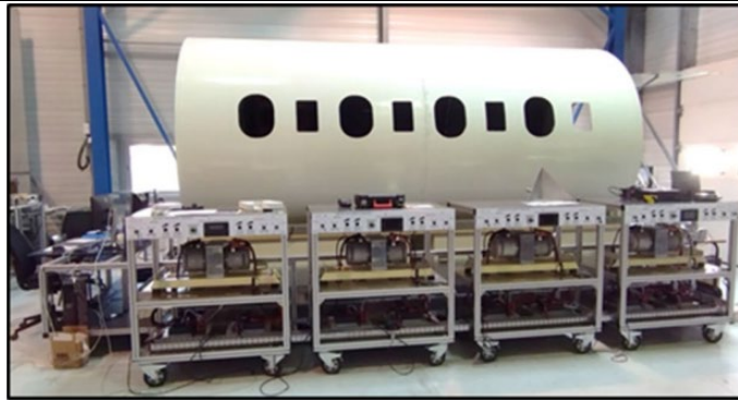
Banc d'essai de propulsion électrique distribuée, TROPHEA, de l'ONERA
