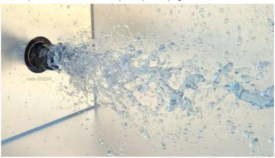
Simulation directe de l'atomisation primaire d'un jet liquide par un écoulement gazeux avec le code DyJeAT, maillage 4 milliards de points, 86000 cœurs de calcul, 45 millions d'heures de simulation
