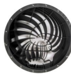
Figure 2 : Dispositif générateur de distorsions conçu par [1]
