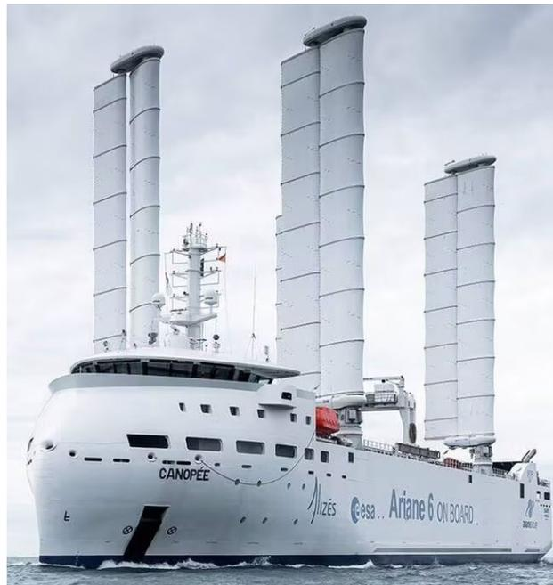
Photo illustrative du navire Canopée équipé des voiles conçus par Ayro
