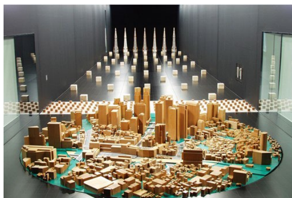
Figure 4 – Configuration de génération de couche limite atmosphérique en soufflerie (Crédits : Shimizu Corporation, Japon)
