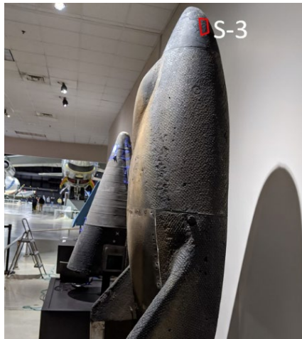
Figure 1 Exemple de surface ablatée sur le véhicule SV-5D [1]
