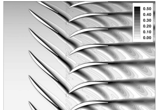
Sillages (visualisation de l'entropie) dans un étage de compresseur résolu par TSM, tiré de [1]
