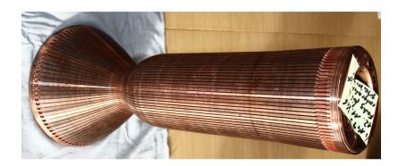
Dans les conditions de fonctionnement nominales du moteur, la très forte pression dans la chambre de combustion et dans les canaux de refroidissement conduit à un régime de fonctionnement au dessus du point critique (en pression), correspondant à un état dit "supercritique" pour lequel l'échauffement du fluide conduit à une évolution continue, plus ou moins rapide, de la densité du fluide, sans notion de changement de phase liquide-vapeur.
