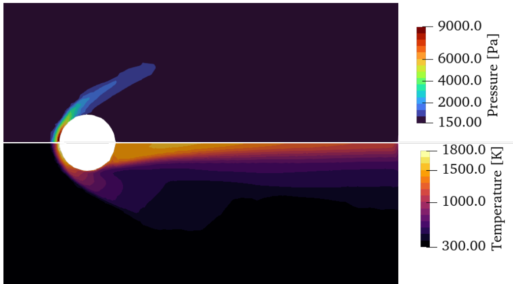
Figure 2 - Calcul 3D d'un écoulement hypersonique autour d'une forme sphérique par le code de calcul CEDRE de l'ONERA.
