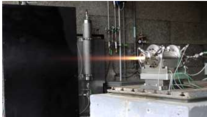
Figure 1- Moteur hybride de recherche HYCOM de l'ONERA
