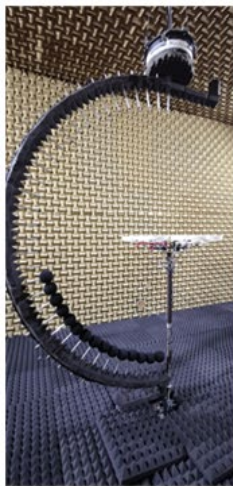
Caractérisation en chambre sourde (à gauche) et en champ libre (à droite) du bruit généré par un drone
