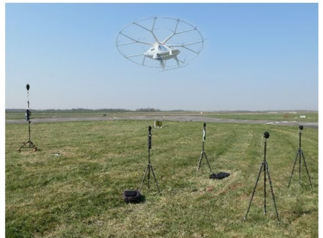
Caractérisation en chambre sourde (à gauche) et en champ libre (à droite) du bruit généré par un drone
